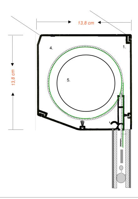
1. Stranggepresster Aluminium Kasten, 4-seitig geschlossen, 3-teilig, abgeschrägt Wandstärke 2.5mm inklusive integrierte Abdichtungsbürsten
