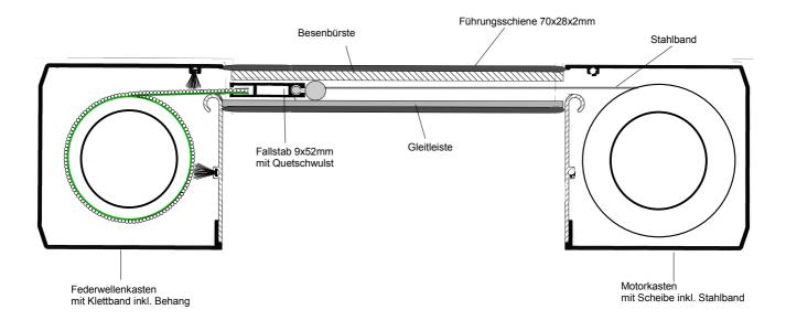
Stranggepresste Aluminium Kästen 4 seitig geschlossen, 2-teilig, mit innenliegenden Abdichtungsbürsten und integrierter Abdruckleiste inklusive unterer Revisionsklappe; Wandstärke 2,5mm
