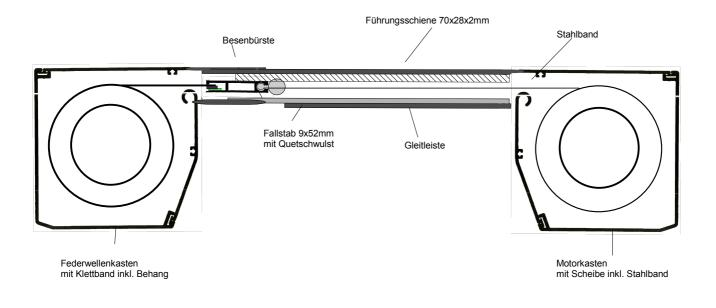
Stranggepresste Aluminium Kästen 4 seitig geschlossen, 3-teilig, mit innenliegenden Abdichtungsbürsten und integrierter Abdruckleiste inklusive unterer Revisionsklappe; Wandstärke 2,5mm
